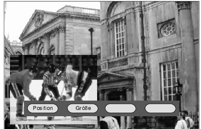
Beim zweiten Druck auf die PIP–Taste erscheinen für das 16:9–Bildschirmformat die "Felder" POSITION und GRÖSSE. Um das Bild zu schieben oder die Größe zu ändern, bedienen Sie einfach die entsprechende farbige Taste auf der Fernbedienung.
